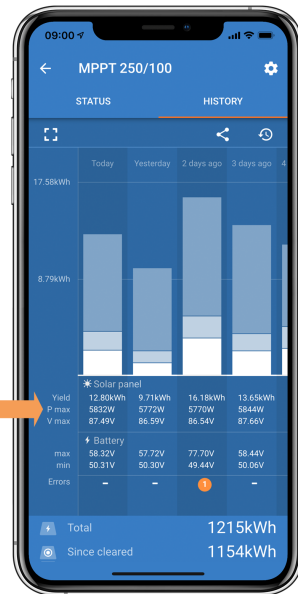
Lectura del historial de Pmax en la aplicación VictronConnect.
