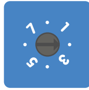
Interruptor giratorio en posición 2
