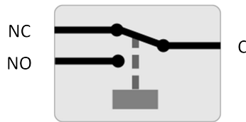
Funcionamiento interno del relé programable
